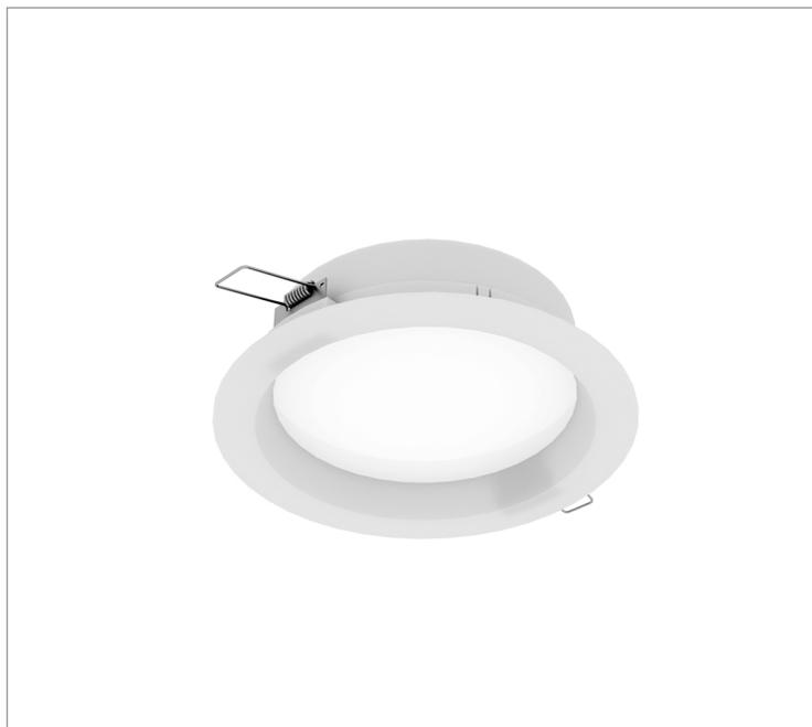
Luminária circular de embutir em forro de gesso, 37W 2700K IRC>80. Corpo em alumínio. Acabamento Branca, Preta ou Especial. Controle óptico principal através de difusor em poliestireno translúcido. Luminária grau de proteção IP-20. Driver corrente constante Liga/Desliga, Triac, 1-10V ou Dali (consultar condições). Tensão de trabalho 220V ou Bivolt.
