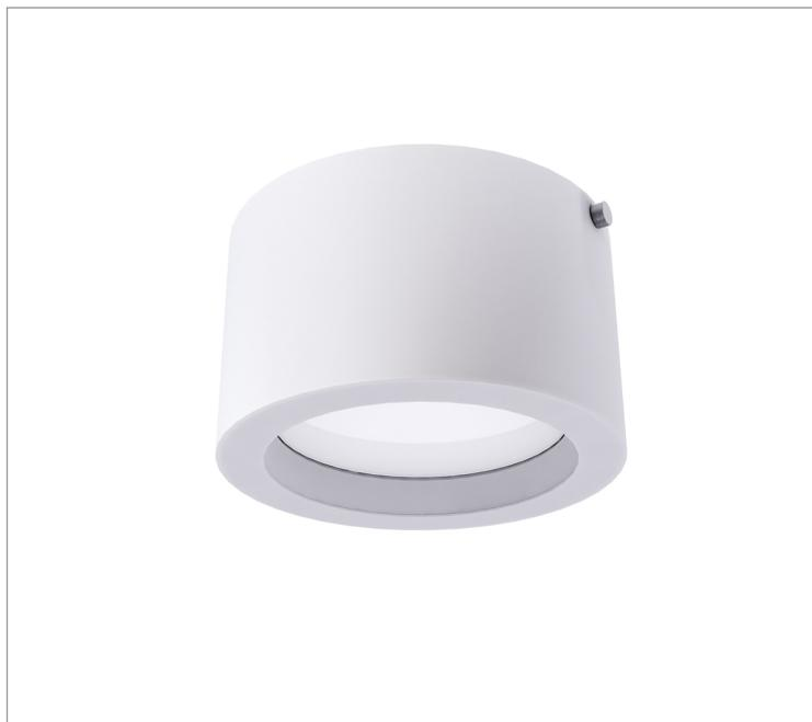
Luminária circular de sobrepor, 10W 5000K IRC>80. Corpo em alumínio. Acabamento Branca, Preta ou Especial. Controle óptico principal através de difusor em acrílico translúcido. Luminária grau de proteção IP-20. Driver corrente constante Liga/Desliga, Triac, 1-10V ou Dali (consultar condições). Tensão de trabalho 220V ou Bivolt.
