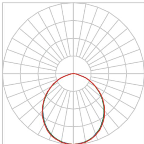
Luminária circular de sobrepor, 14W 3000K IRC>80. Corpo em alumínio. Acabamento Branca, Preta ou Especial. Controle óptico principal através de difusor em acrílico translúcido. Luminária grau de proteção IP-20. Driver corrente constante Liga/Desliga, Triac, 1-10V ou Dali (consultar condições). Tensão de trabalho 220V ou Bivolt.
