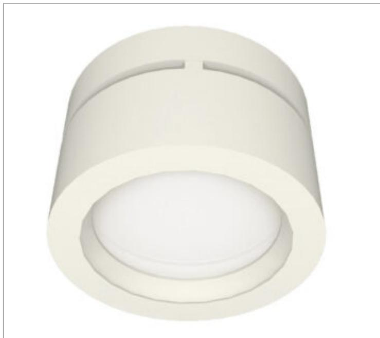
Luminária circular de sobrepor, 37W 5000K IRC>95. Corpo em alumínio. Acabamento Branca, Preta ou Especial. Controle óptico principal através de difusor em acrílico translúcido. Luminária grau de proteção IP-20. Driver corrente constante Liga/Desliga, Triac, 1-10V ou Dali (consultar condições). Tensão de trabalho 220V ou Bivolt.
