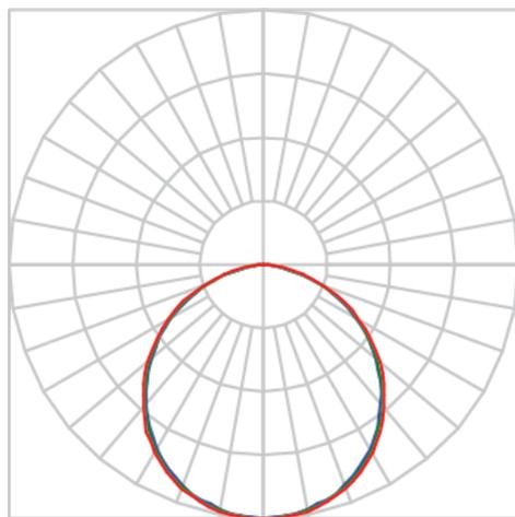
Luminária circular de sobrepor, 28W 3000K IRC>80. Corpo em alumínio. Acabamento Branca, Preta ou Especial. Controle óptico principal através de difusor em poliestireno translúcido. Luminária grau de proteção IP-20. Driver corrente constante Liga/Desliga, Triac, 1-10V ou Dali (consultar condições). Tensão de trabalho 220V ou Bivolt.
