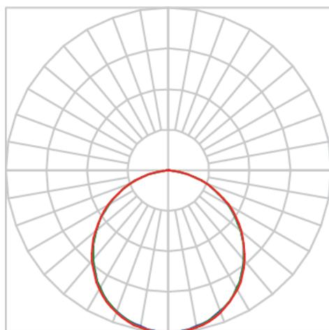
Luminária circular de sobrepor, 28W 5000K IRC>80. Corpo em alumínio. Acabamento Branca, Preta ou Especial. Controle óptico principal através de difusor em poliestireno translúcido. Luminária grau de proteção IP-20. Driver corrente constante Liga/Desliga, Triac, 1-10V ou Dali (consultar condições). Tensão de trabalho 220V ou Bivolt.
