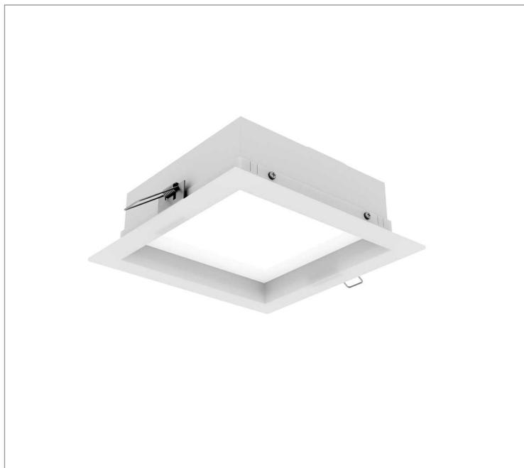
Luminária quadrada de embutir em forro de gesso, 14W 2700K IRC>80. Corpo em alumínio. Acabamento Branca, Preta ou Especial. Controle óptico principal através de difusor em acrílico translúcido. Luminária grau de proteção IP-20. Driver corrente constante Liga/Desliga, Triac, 1-10V ou Dali (consultar condições). Tensão de trabalho 220V ou Bivolt.
