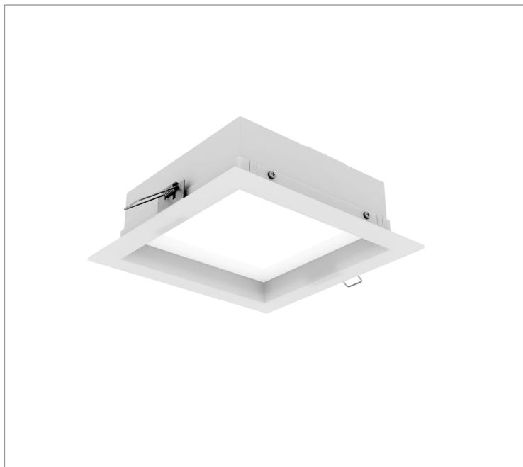
Luminária quadrada de embutir em forro de gesso, 28W 2700K IRC>80. Corpo em alumínio. Acabamento Branca, Preta ou Especial. Controle óptico principal através de difusor em acrílico translúcido. Luminária grau de proteção IP-20. Driver corrente constante Liga/Desliga, Triac, 1-10V ou Dali (consultar condições). Tensão de trabalho 220V ou Bivolt.
