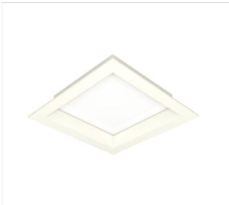
Luminária quadrada de embutir em forro de gesso, 28W 4000K IRC>80. Corpo em alumínio. Acabamento Branca, Preta ou Especial. Controle óptico principal através de difusor em acrílico translúcido. Luminária grau de proteção IP-20. Driver corrente constante Liga/Desliga, Triac, 1-10V ou Dali (consultar condições). Tensão de trabalho 220V ou Bivolt.
