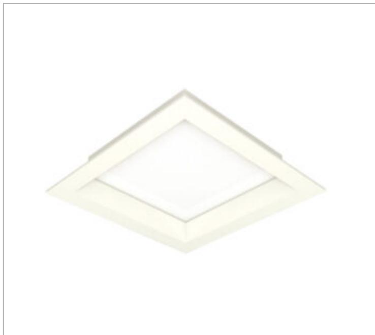
Luminária quadrada de embutir em forro de gesso, 7W 6500K IRC>80. Corpo em alumínio. Acabamento Branca, Preta ou Especial. Controle óptico principal através de difusor em acrílico translúcido. Luminária grau de proteção IP-20. Driver corrente constante Liga/Desliga, Triac, 1-10V ou Dali (consultar condições). Tensão de trabalho 220V ou Bivolt.
