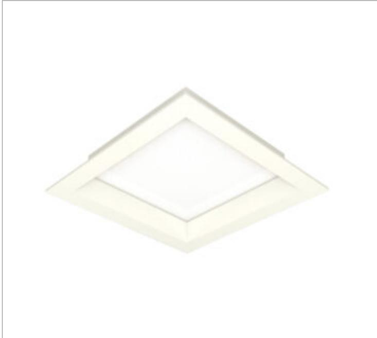
Luminária quadrada de embutir em forro de gesso, 14W 2700K IRC>80. Corpo em alumínio. Acabamento Branca, Preta ou Especial. Controle óptico principal através de difusor em poliestireno translúcido. Luminária grau de proteção IP-20. Driver corrente constante Liga/Desliga, Triac, 1-10V ou Dali (consultar condições). Tensão de trabalho 220V ou Bivolt.
