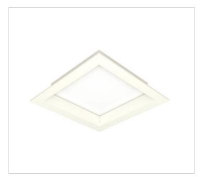
Luminária quadrada de embutir em forro de gesso, 14W 5000K IRC>80. Corpo em alumínio. Acabamento Branca, Preta ou Especial. Controle óptico principal através de difusor em poliestireno translúcido. Luminária grau de proteção IP-20. Driver corrente constante Liga/Desliga, Triac, 1-10V ou Dali (consultar condições). Tensão de trabalho 220V ou Bivolt.
