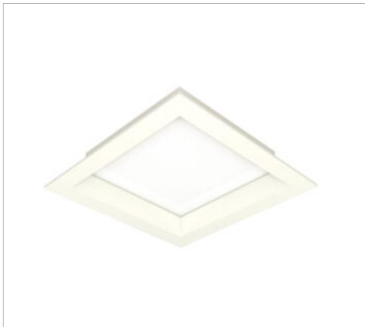
Luminária quadrada de embutir em forro de gesso, 37W 4000K IRC>80. Corpo em alumínio. Acabamento Branca, Preta ou Especial. Controle óptico principal através de difusor em poliestireno translúcido. Luminária grau de proteção IP-20. Driver corrente constante Liga/Desliga, Triac, 1-10V ou Dali (consultar condições). Tensão de trabalho 220V ou Bivolt.
