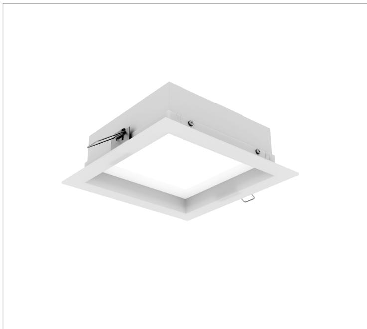
Luminária quadrada de embutir em forro de gesso, 7W 2700K IRC>80. Corpo em alumínio. Acabamento Branca, Preta ou Especial. Controle óptico principal através de difusor em poliestireno translúcido. Luminária grau de proteção IP-20. Driver corrente constante Liga/Desliga, Triac, 1-10V ou Dali (consultar condições). Tensão de trabalho 220V ou Bivolt.
