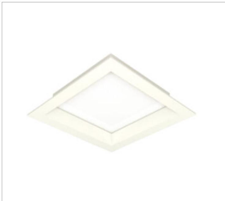
Luminária quadrada de embutir em forro de gesso, 7W 2700K IRC>95. Corpo em alumínio. Acabamento Branca, Preta ou Especial. Controle óptico principal através de difusor em poliestireno translúcido. Luminária grau de proteção IP-20. Driver corrente constante Liga/Desliga, Triac, 1-10V ou Dali (consultar condições). Tensão de trabalho 220V ou Bivolt.
