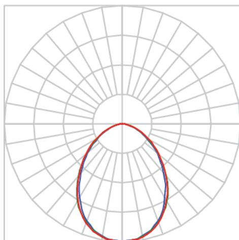
Luminária quadrada de sobrepor, 10W 3000K IRC>80. Corpo em alumínio. Acabamento Branca, Preta ou Especial. Controle óptico principal através de difusor em acrílico translúcido. Luminária grau de proteção IP-20. Driver corrente constante Liga/Desliga, Triac, 1-10V ou Dali (consultar condições). Tensão de trabalho 220V ou Bivolt.
