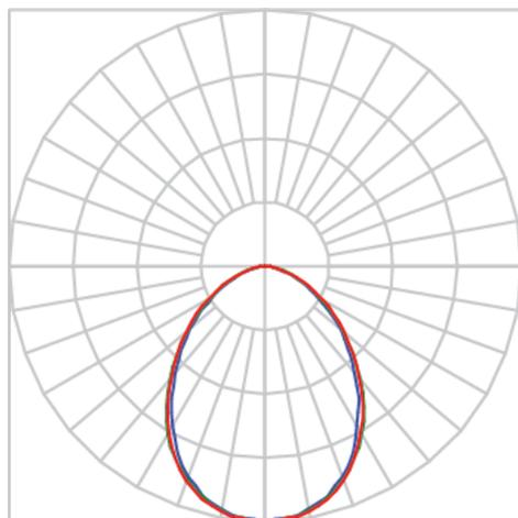
Luminária quadrada de sobrepor, 7W 3000K IRC>80. Corpo em alumínio. Acabamento Branca, Preta ou Especial. Controle óptico principal através de difusor em acrílico translúcido. Luminária grau de proteção IP-20. Driver corrente constante Liga/Desliga, Triac, 1-10V ou Dali (consultar condições). Tensão de trabalho 220V ou Bivolt.
