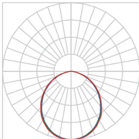
Luminária quadrada de sobrepor, 14W 3000K IRC>80. Corpo em alumínio. Acabamento Branca, Preta ou Especial. Controle óptico principal através de difusor em poliestireno translúcido. Luminária grau de proteção IP-20. Driver corrente constante Liga/Desliga, Triac, 1-10V ou Dali (consultar condições). Tensão de trabalho 220V ou Bivolt.
