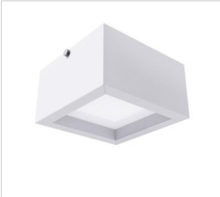
Luminária quadrada de sobrepor, 14W 3000K IRC>95. Corpo em alumínio. Acabamento Branca, Preta ou Especial. Controle óptico principal através de difusor em poliestireno translúcido. Luminária grau de proteção IP-20. Driver corrente constante Liga/Desliga, Triac, 1-10V ou Dali (consultar condições). Tensão de trabalho 220V ou Bivolt.
