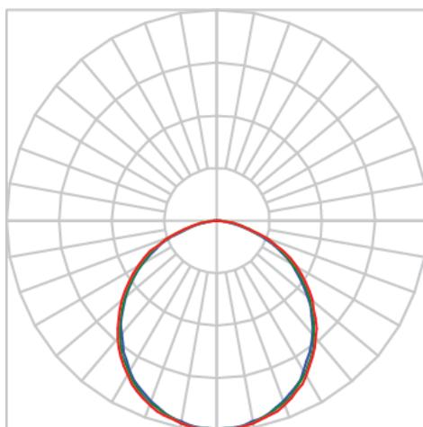
Luminária quadrada de sobrepor, 28W 3000K IRC>80. Corpo em alumínio. Acabamento Branca, Preta ou Especial. Controle óptico principal através de difusor em poliestireno translúcido. Luminária grau de proteção IP-20. Driver corrente constante Liga/Desliga, Triac, 1-10V ou Dali (consultar condições). Tensão de trabalho 220V ou Bivolt.
