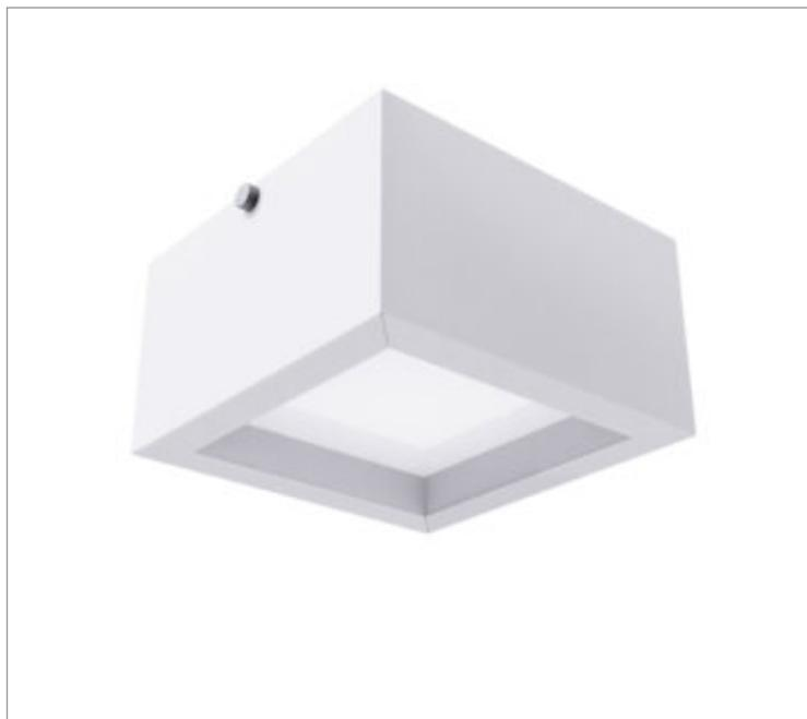
Luminária quadrada de sobrepor, 28W 4000K IRC>80. Corpo em alumínio. Acabamento Branca, Preta ou Especial. Controle óptico principal através de difusor em poliestireno translúcido. Luminária grau de proteção IP-20. Driver corrente constante Liga/Desliga, Triac, 1-10V ou Dali (consultar condições). Tensão de trabalho 220V ou Bivolt.
