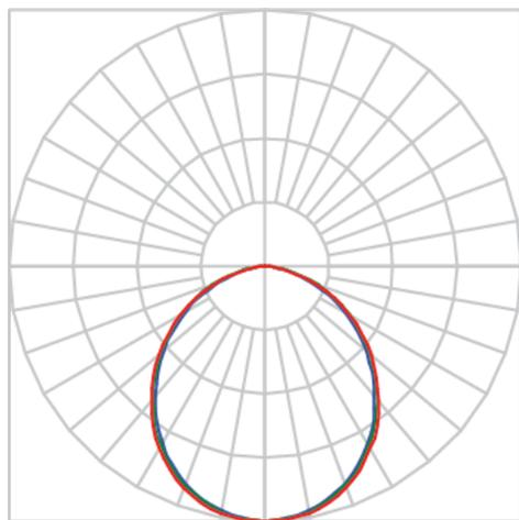
Luminária quadrada de sobrepor, 37W 4000K IRC>80. Corpo em alumínio. Acabamento Branca, Preta ou Especial. Controle óptico principal através de difusor em poliestireno translúcido. Luminária grau de proteção IP-20. Driver corrente constante Liga/Desliga, Triac, 1-10V ou Dali (consultar condições). Tensão de trabalho 220V ou Bivolt.
