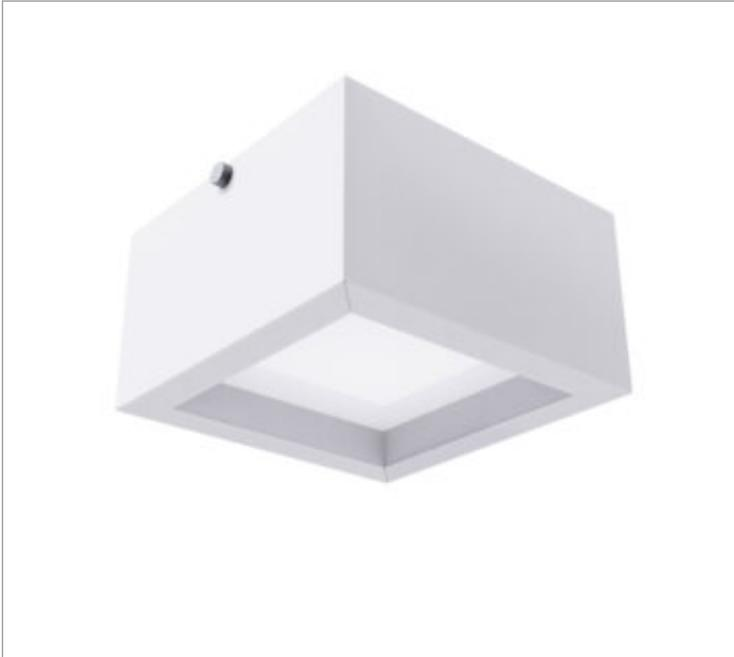
Luminária quadrada de sobrepor, 7W 3000K IRC>95. Corpo em alumínio. Acabamento Branca, Preta ou Especial. Controle óptico principal através de difusor em poliestireno translúcido. Luminária grau de proteção IP-20. Driver corrente constante Liga/Desliga, Triac, 1-10V ou Dali (consultar condições). Tensão de trabalho 220V ou Bivolt.
