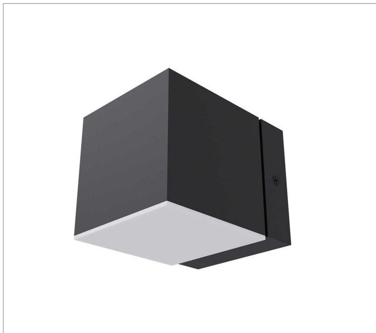
Luminária quadrada arandela iluminação direta e indireta, 8W 2700K IRC>80. Corpo em alumínio. Acabamento Branca, Preta ou Especial. Controle óptico principal através de facho Difuso Direto e Indireto. Luminária grau de proteção IP-20. Driver corrente constante Liga/Desliga Tensão de trabalho 127V ou 220V.
