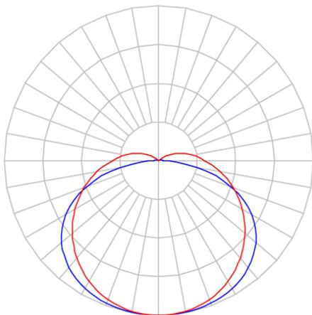
Luminária retangular para perfilado, 54W 3000K IRC>80. Corpo em policarbonato. Acabamento cinza. Controle óptico principal através de difusor em policarbonato translúcido. Luminária grau de proteção IP-65. Driver corrente constante Liga/Desliga, Triac, 1-10V ou Dali (consultar condições). Tensão de trabalho 220V ou Bivolt.
