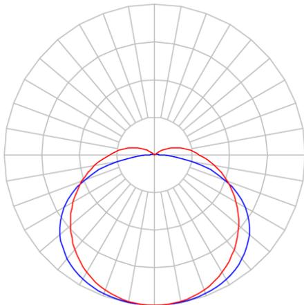
Luminária retangular para perfilado, 54W 4000K IRC>80. Corpo em policarbonato. Acabamento cinza. Controle óptico principal através de difusor em policarbonato translúcido. Luminária grau de proteção IP-65. Driver corrente constante Liga/Desliga, Triac, 1-10V ou Dali (consultar condições). Tensão de trabalho 220V ou Bivolt.
