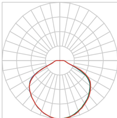
Luminária circular pendente iluminação direta, 14W 2700K IRC>80. Corpo em alumínio. Acabamento Branca, Preta ou Especial. Controle óptico principal através de refletor facho difuso. Luminária grau de proteção IP-20. Driver corrente constante Liga/Desliga, Triac, 1-10V ou Dali (consultar condições). Tensão de trabalho 220V ou Bivolt.
