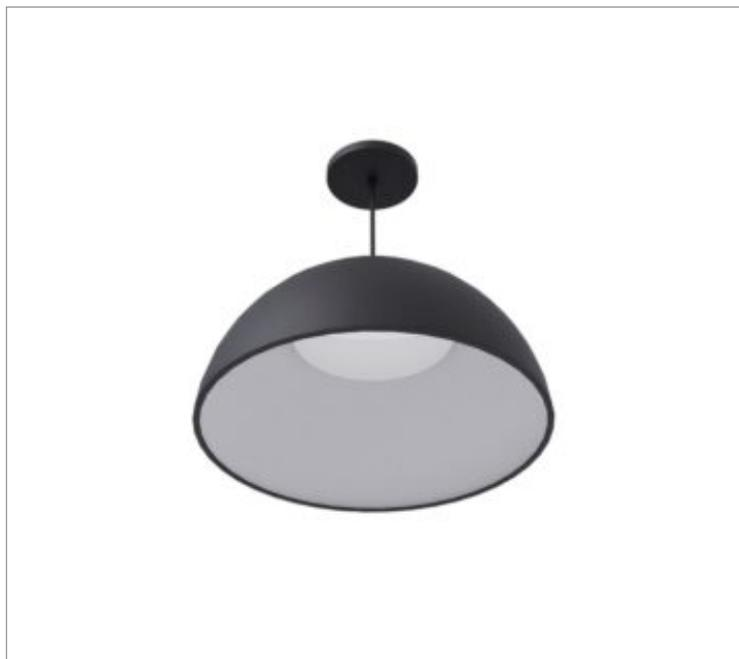
Luminária circular pendente iluminação direta, 14W 4000K IRC>95. Corpo em alumínio. Acabamento Branca, Preta ou Especial. Controle óptico principal através de refletor fecho difuso. Luminária grau de proteção IP-20. Driver corrente constante Liga/Desliga, Triac, 1-10V ou Dali (consultar condições). Tensão de trabalho 220V ou Bivolt.
