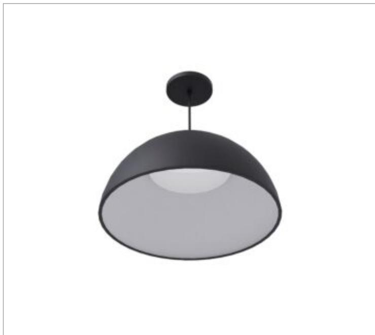
Luminária circular pendente iluminação direta, 28W 3000K IRC>80. Corpo em alumínio. Acabamento Branca, Preta ou Especial. Controle óptico principal através de refletor fecho difuso. Luminária grau de proteção IP-20. Driver corrente constante Liga/Desliga, Triac, 1-10V ou Dali (consultar condições). Tensão de trabalho 220V ou Bivolt.
