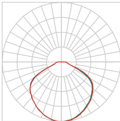
Luminária circular pendente iluminação direta, 7W 3000K IRC>80. Corpo em alumínio. Acabamento Branca, Preta ou Especial. Controle óptico principal através de refletor facho difuso. Luminária grau de proteção IP-20. Driver corrente constante Liga/Desliga, Triac, 1-10V ou Dali (consultar condições). Tensão de trabalho 220V ou Bivolt.
