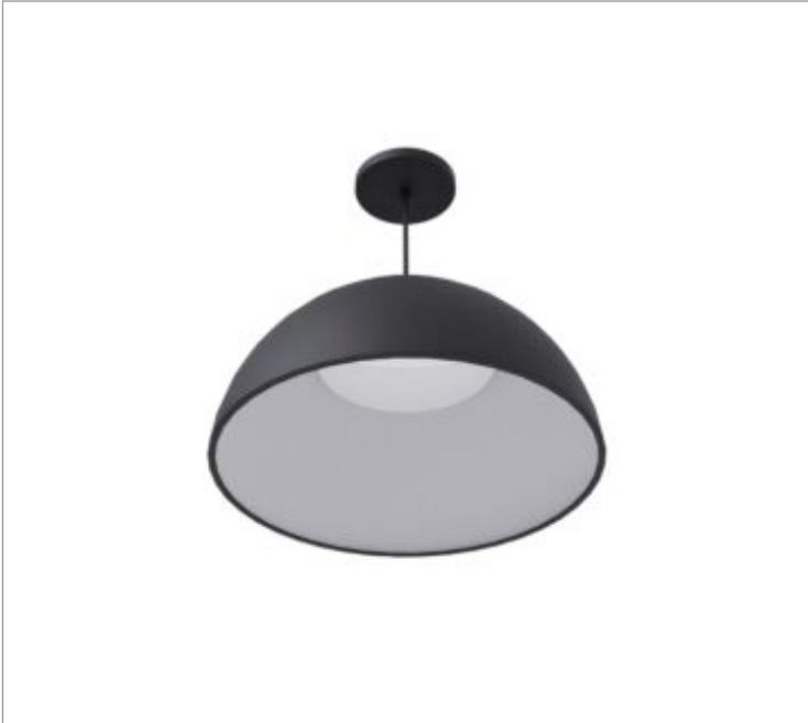
Luminária circular pendente iluminação direta, 7W 3000K IRC>95. Corpo em alumínio. Acabamento Branca, Preta ou Especial. Controle óptico principal através de refletor facho difuso. Luminária grau de proteção IP-20. Driver corrente constante Liga/Desliga, Triac, 1-10V ou Dali (consultar condições). Tensão de trabalho 220V ou Bivolt.
