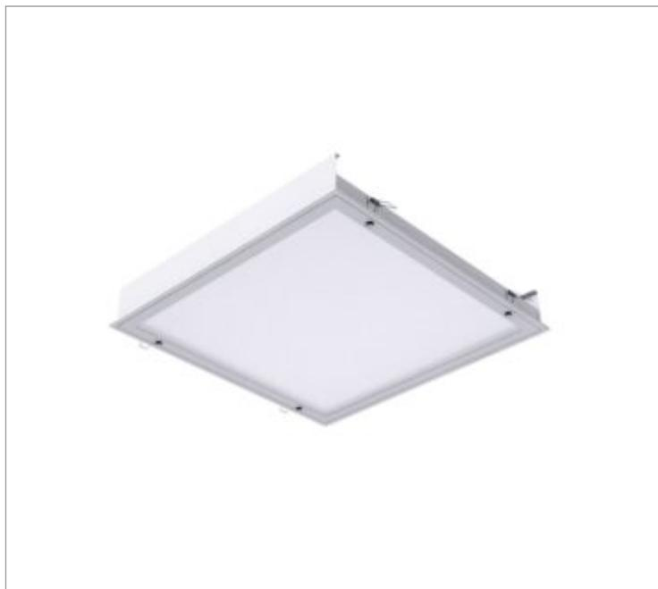
Luminária quadrada de embutir em forro de gesso, 40W 2700K IRC>80. Corpo em alumínio. Acabamento Branca, Preta ou Especial. Controle óptico principal através de difusor em poliestireno translúcido. Luminária grau de proteção IP-20. Driver corrente constante Liga/Desliga, Triac, 1-10V ou Dali (consultar condições). Tensão de trabalho 220V ou Bivolt.
