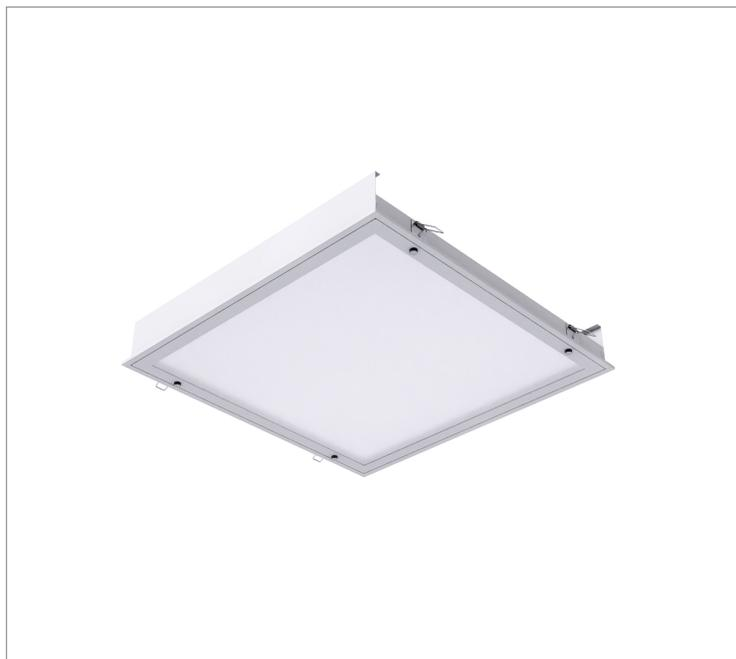
Luminária quadrada de embutir em forro de gesso, 56W 3000K IRC>80. Corpo em alumínio. Acabamento Branca, Preta ou Especial. Controle óptico principal através de difusor em poliestireno translúcido. Luminária grau de proteção IP-20. Driver corrente constante Liga/Desliga, Triac, 1-10V ou Dali (consultar condições). Tensão de trabalho 220V ou Bivolt.
