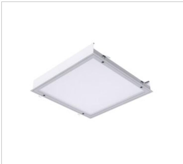
Luminária quadrada de embutir em forro modulado, 34W 5000K IRC>80. Corpo em alumínio. Acabamento Branca, Preta ou Especial. Controle óptico principal através de difusor em poliestireno translúcido. Luminária grau de proteção IP-20. Driver corrente constante Liga/Desliga, Triac, 1-10V ou Dali (consultar condições). Tensão de trabalho 220V ou Bivolt.
