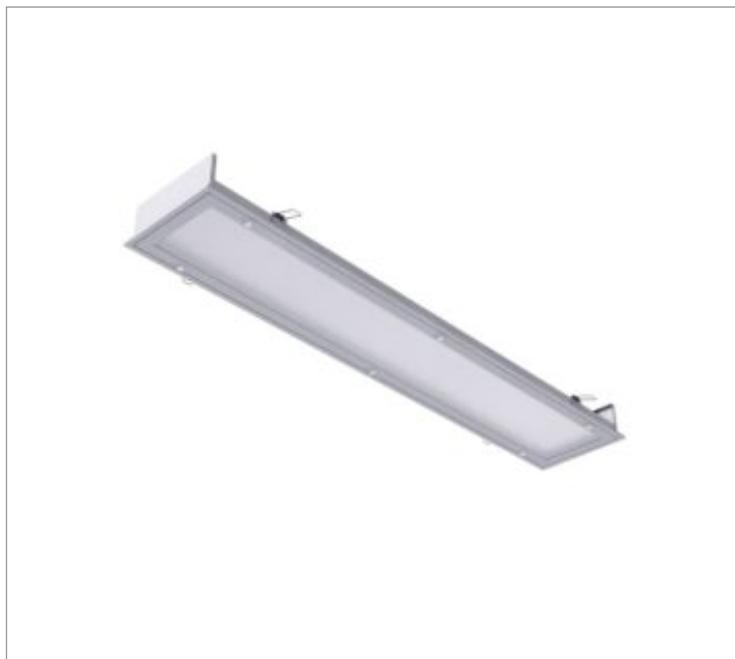
Luminária retangular de embutir em forro de gesso, 20W 4000K IRC>95. Corpo em alumínio. Acabamento Branca, Preta ou Especial. Controle óptico principal através de difusor em poliestireno translúcido. Luminária grau de proteção IP-20. Driver corrente constante Liga/Desliga, Triac, 1-10V ou Dali (consultar condições). Tensão de trabalho 220V ou Bivolt.
