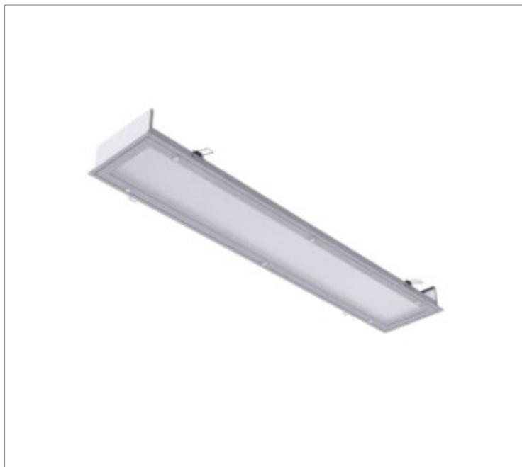
Luminária retangular de embutir em forro de gesso, 20W 2700K IRC>80. Corpo em alumínio. Acabamento Branca, Preta ou Especial. Controle óptico principal através de difusor em poliestireno translúcido. Luminária grau de proteção IP-20. Driver corrente constante Liga/Desliga, Triac, 1-10V ou Dali (consultar condições). Tensão de trabalho 220V ou Bivolt.
