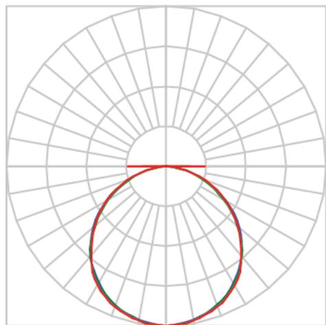
Luminária retangular de embutir em forro de gesso, 34W 5000K IRC>80. Corpo em alumínio. Acabamento Branca, Preta ou Especial. Controle óptico principal através de difusor em poliestireno translúcido. Luminária grau de proteção IP-20. Driver corrente constante Liga/Desliga, Triac, 1-10V ou Dali (consultar condições). Tensão de trabalho 220V ou Bivolt.
