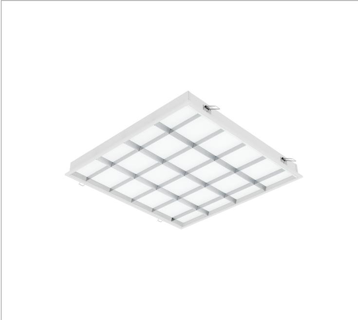
Luminária quadrada de embutir em forro de gesso, 40W 5000K IRC>80. Corpo em alumínio. Acabamento Branca, Preta ou Especial. Controle óptico principal através de fecho difuso. Luminária grau de proteção IP-20. Driver corrente constante Liga/Desliga, Triac, 1-10V ou Dali (consultar condições). Tensão de trabalho 220V ou Bivolt.
