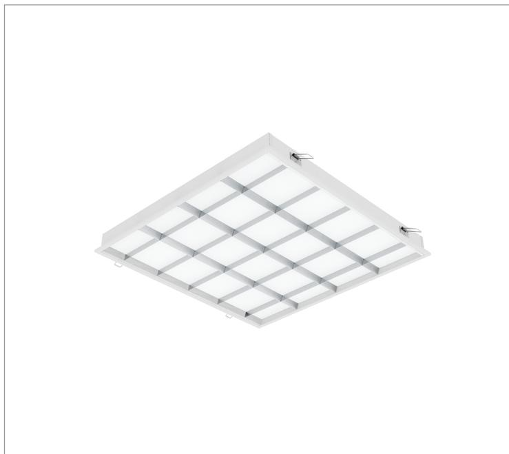
Luminária quadrada de embutir em forro modulado, 40W 3000K IRC>80. Corpo em alumínio. Acabamento Branca, Preta ou Especial. Controle óptico principal através de fecho difuso. Luminária grau de proteção IP-20. Driver corrente constante Liga/Desliga, Triac, 1-10V ou Dali (consultar condições). Tensão de trabalho 220V ou Bivolt.
