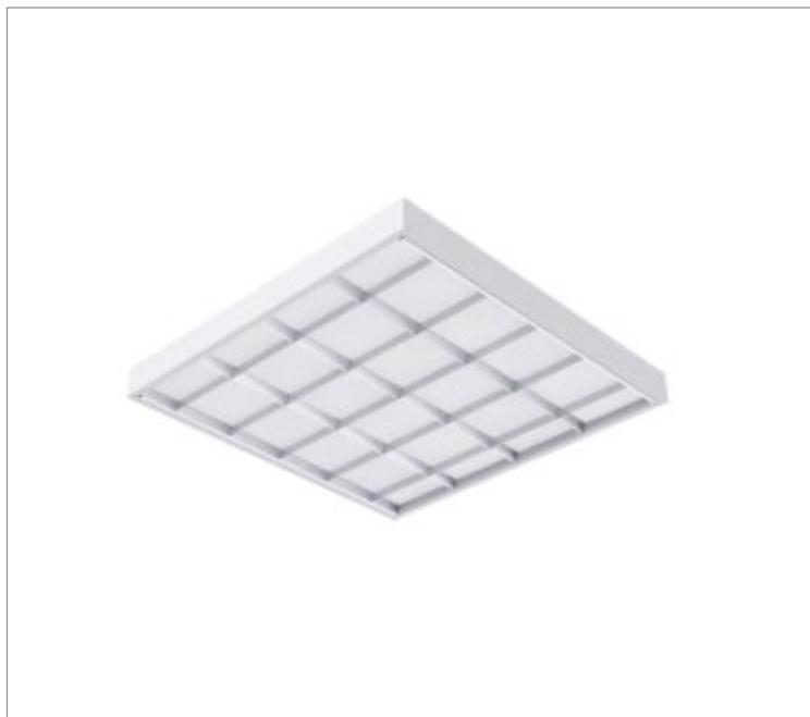
Luminária quadrada de sobrepor, 40W 4000K IRC>80. Corpo em alumínio. Acabamento Branca, Preta ou Especial. Controle óptico principal através de fecho difuso. Luminária grau de proteção IP-20. Driver corrente constante Liga/Desliga, Triac, 1-10V ou Dali (consultar condições). Tensão de trabalho 220V ou Bivolt.
