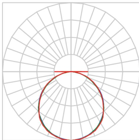
Luminária retangular de sobrepor, 20W 2700K IRC>80. Corpo em alumínio. Acabamento Branca, Preta ou Especial. Controle óptico principal através de fecho difuso. Luminária grau de proteção IP-20. Driver corrente constante Liga/Desliga, Triac, 1-10V ou Dali (consultar condições). Tensão de trabalho 220V ou Bivolt.
