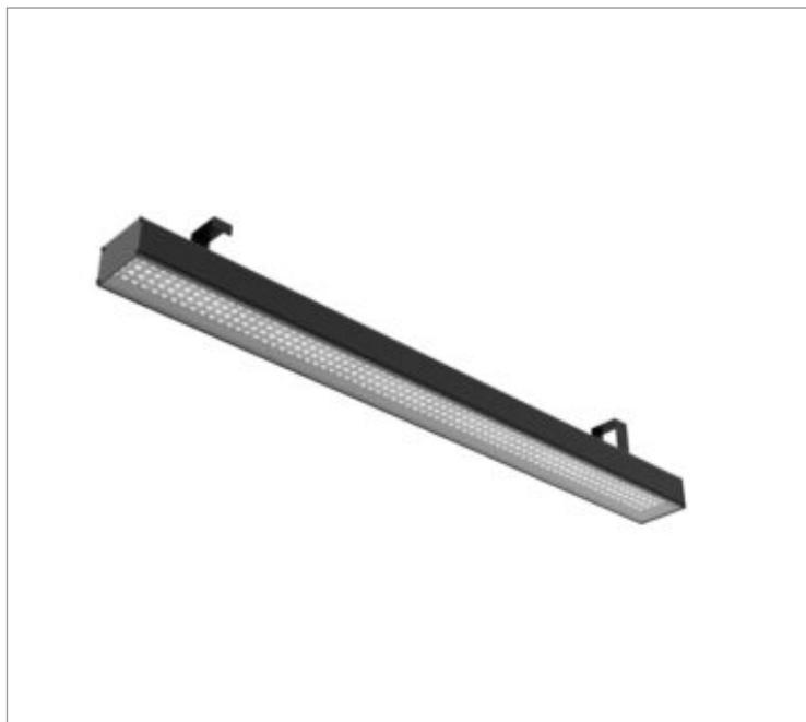
Luminária retangular para perfilado, 25W 4000K IRC>80. Corpo em alumínio. Acabamento Branca, Preta ou Especial. Controle óptico principal através de lente facho 20°. Luminária grau de proteção IP-54ou65 (consultar condições). Driver corrente constante Liga/Desliga, Triac, 1-10V ou Dali (consultar condições). Tensão de trabalho 220V ou Bivolt.
