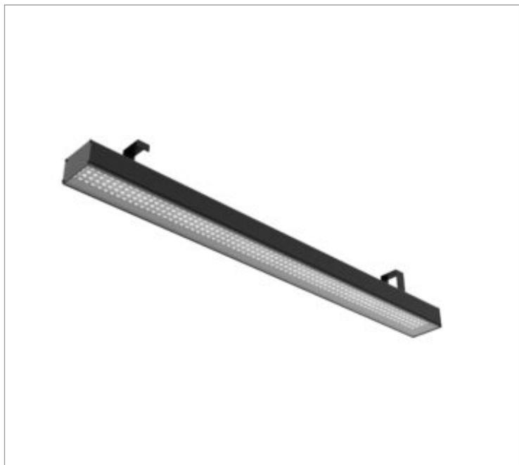
Luminária retangular para perfilado, 50W 5000K IRC>80. Corpo em alumínio. Acabamento Branca, Preta ou Especial. Controle óptico principal através de lente facho 20-60°. Luminária grau de proteção IP-54ou65 (consultar condições). Driver corrente constante Liga/Desliga, Triac, 1-10V ou Dali (consultar condições). Tensão de trabalho 220V ou Bivolt.
