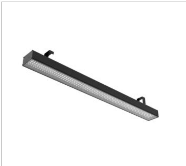
Luminária retangular para perfilado, 75W 3000K IRC>80. Corpo em alumínio. Acabamento Branca, Preta ou Especial. Controle óptico principal através de lente facho 20-60°. Luminária grau de proteção IP-54ou65 (consultar condições). Driver corrente constante Liga/Desliga, Triac, 1-10V ou Dali (consultar condições). Tensão de trabalho 220V ou Bivolt.
