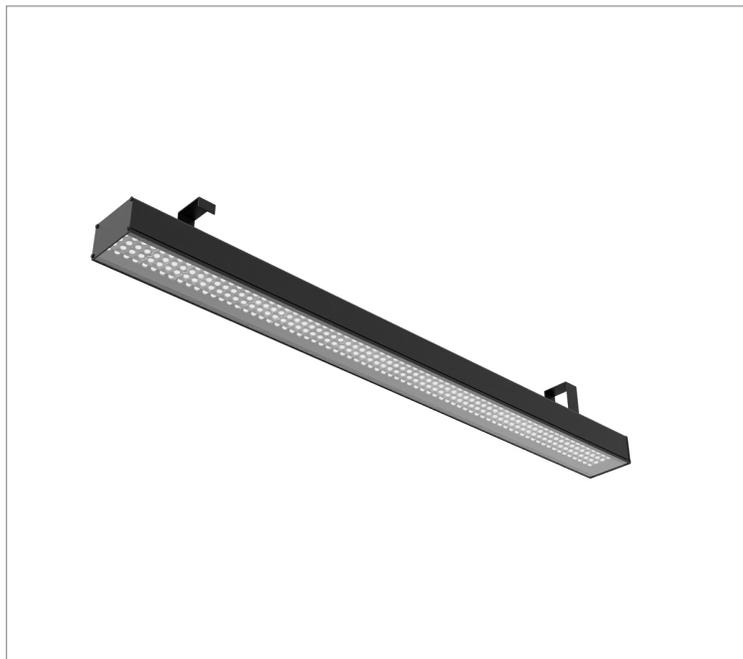
Luminária retangular para perfilado, 75W 5000K IRC>80. Corpo em alumínio. Acabamento Branca, Preta ou Especial. Controle óptico principal através de lente facho 20-60°. Luminária grau de proteção IP-65. Driver corrente constante Liga/Desliga, Triac, 1-10V ou Dali (consultar condições). Tensão de trabalho 220V ou Bivolt.
