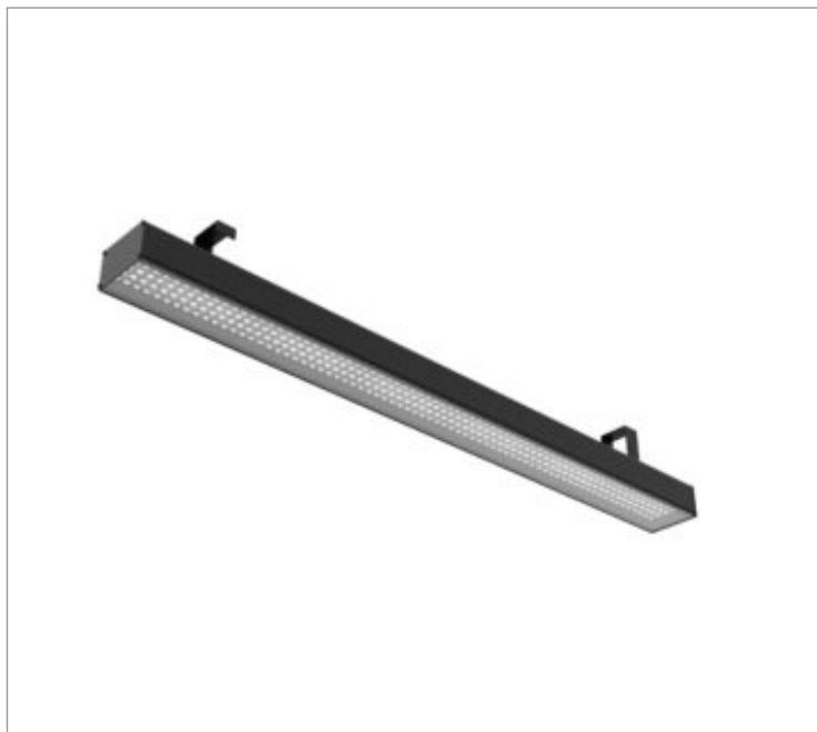
Luminária retangular para perfilado, 50W 3000K IRC>95. Corpo em alumínio. Acabamento Branca, Preta ou Especial. Controle óptico principal através de lente facho 30°. Luminária grau de proteção IP-54ou65 (consultar condições). Driver corrente constante Liga/Desliga, Triac, 1-10V ou Dali (consultar condições). Tensão de trabalho 220V ou Bivolt.
