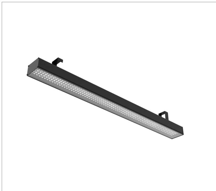
Luminária retangular para perfilado, 50W 4000K IRC>80. Corpo em alumínio. Acabamento Branca, Preta ou Especial. Controle óptico principal através de lente facho 30°. Luminária grau de proteção IP-65. Driver corrente constante Liga/Desliga, Triac, 1-10V ou Dali (consultar condições). Tensão de trabalho 220V ou Bivolt.
