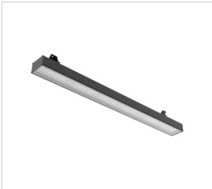
Projektor, 175W 2700K IRC>95. Corpo em alumínio. Acabamento Branca, Preta ou Especial. Controle óptico principal através de lente facho 20°. Luminária grau de proteção IP-54ou65 (consultar condições). Driver corrente constante Liga/Desliga, Triac, 1-10V ou Dali (consultar condições). Tensão de trabalho 220V ou Bivolt.
