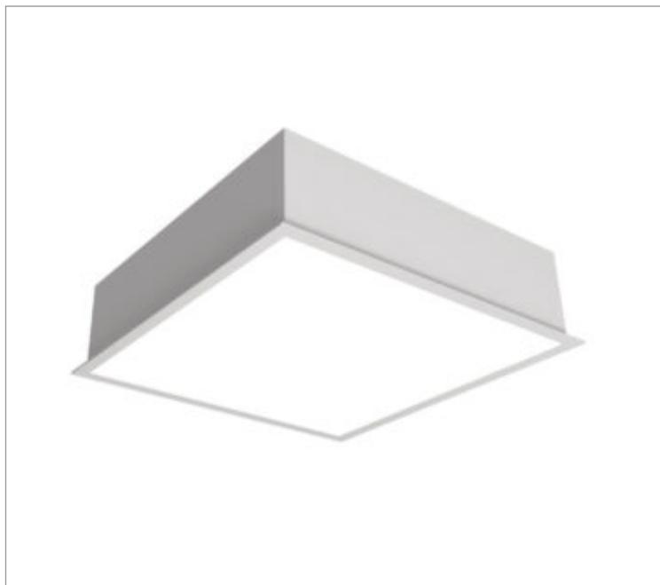
Luminária quadrada de embutir em forro de gesso, 20W 4000K IRC>95. Corpo em alumínio. Acabamento Branca, Preta ou Especial. Controle óptico principal através de difusor em poliestireno translúcido. Luminária grau de proteção IP-20. Driver corrente constante Liga/Desliga Tensão de trabalho 220V ou Bivolt.
