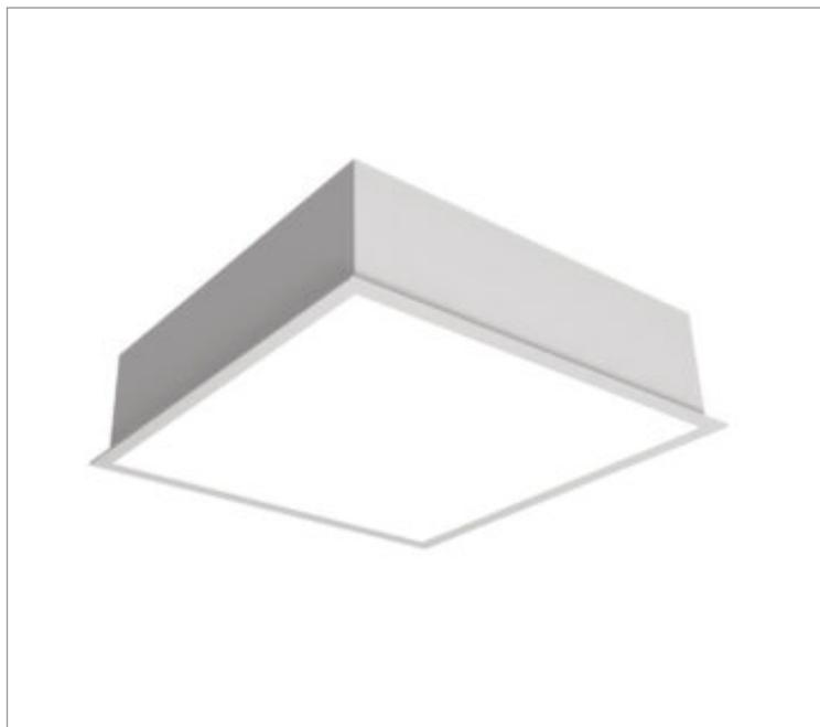
Luminária quadrada de embutir em forro de gesso, 56W 6500K IRC>80. Corpo em alumínio. Acabamento Branca, Preta ou Especial. Controle óptico principal através de difusor em poliestireno translúcido. Luminária grau de proteção IP-20. Driver corrente constante Liga/Desliga Tensão de trabalho 220V ou Bivolt.
